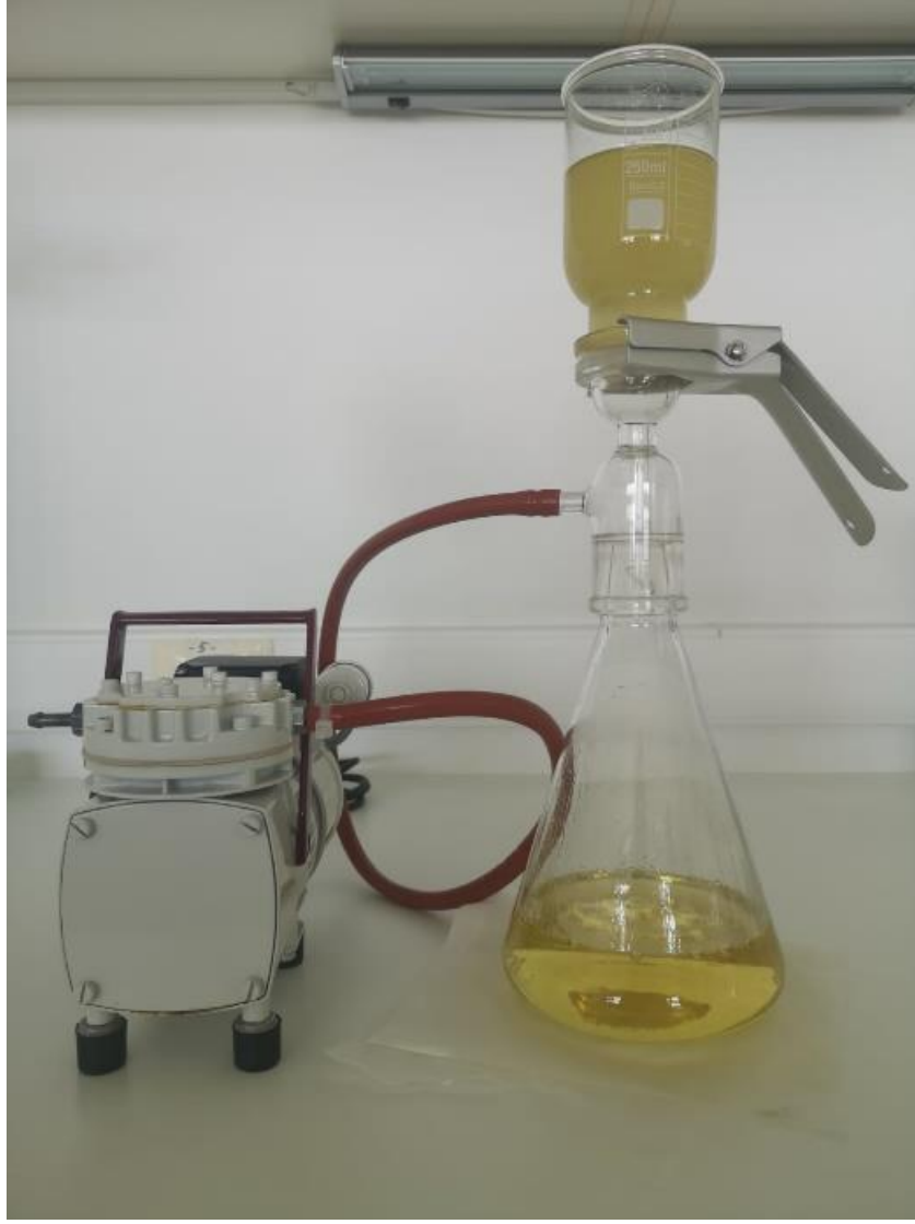
Şekil 2. 8. Vakum pompası ile filtreleme
