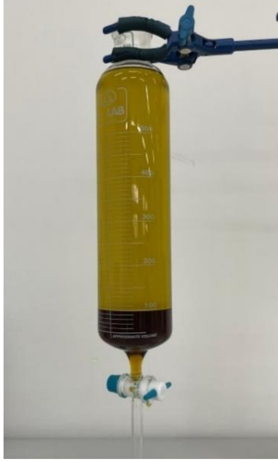
Şekil 2. 7. Ayırma hunisinde gliserin ve metil ester karışımı
