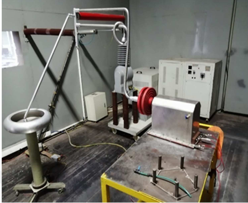
Şekil 4.35.Hava, SF6 ve R410A yalıtımlı gerilim transformatörü kısmi deşarj deney düzeneği (ESİTAŞ Elektrik Laboratuvarı)
