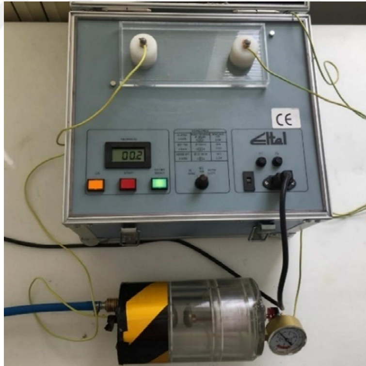
Şekil 3.5. Küresel elektrot sisteminde delinme gerilimi test düzeneği
