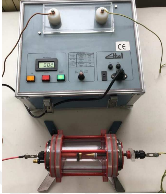
Şekil 3.9. Koni-düzlem elektrot sisteminde delinme gerilimi test düzeneği
