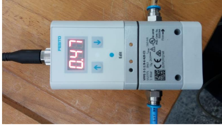
Şekil 3.26. Festo VPPE 3-1-1/8-6-420-E1 oransal basınç regülatörü
