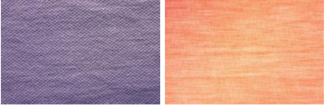
Şekil 3.7. Yüksek düzgünsüzlük değerine sahip ipliklerden yapılan farklı iki renkteki örme kumaşlar (Uster Technologies AG, 2013)
