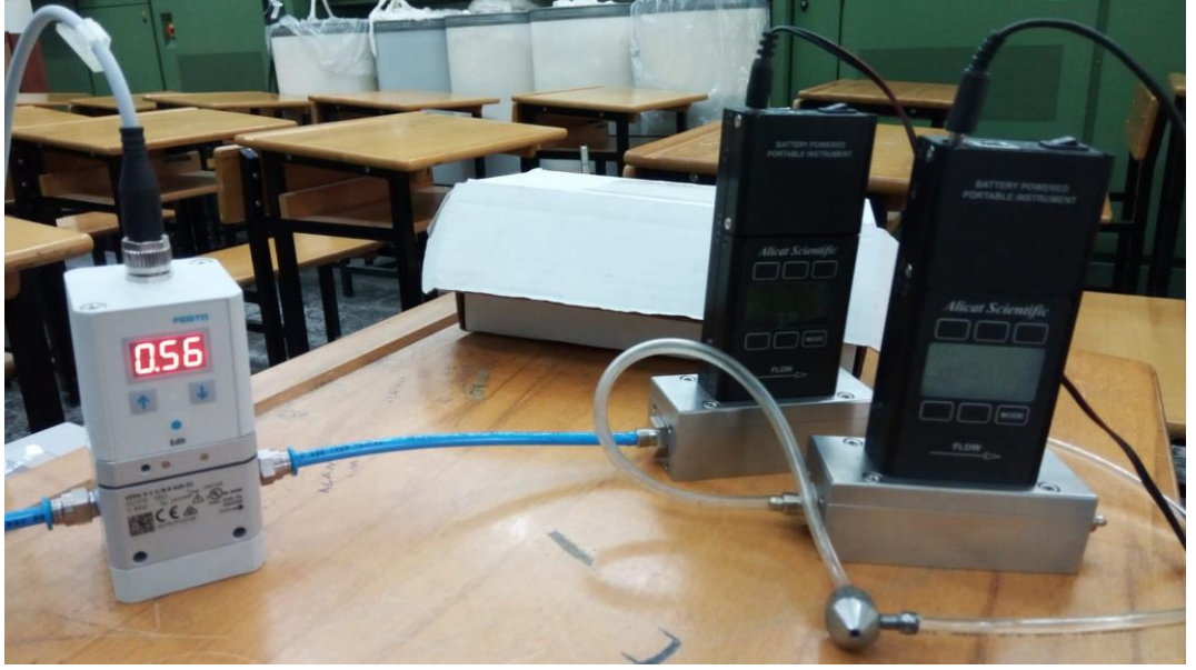
Şekil 3.27. Alicat Scientific Marka M serisi kütleli debimetreler ile kütleli ve hacimsel debi ölçümlerinin yapılması
