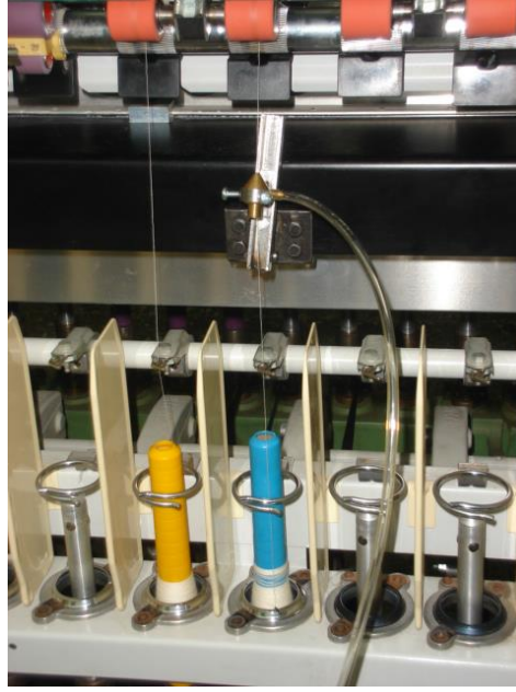
Şekil 3.2. Rieter G10 konvansiyonel ring iplik eğirme makinesinde Jetring (sağda) ve konvansiyonel ring iplik (solda) üretimi
