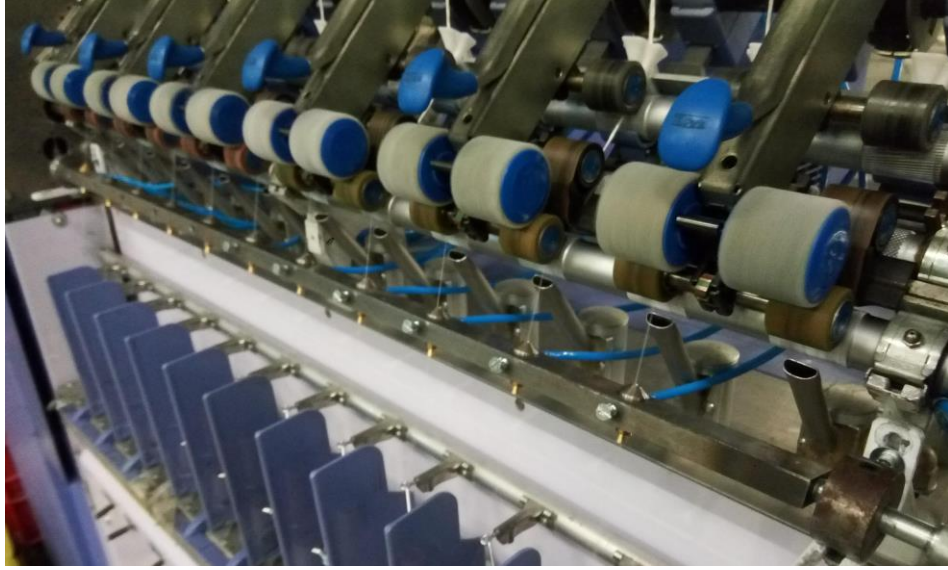
Şekil 3.28. Merlin marka konvansiyonel ring iplik eğirme makinesine 10 adet konvansiyonel hava düzesinin entegre edilmesi
