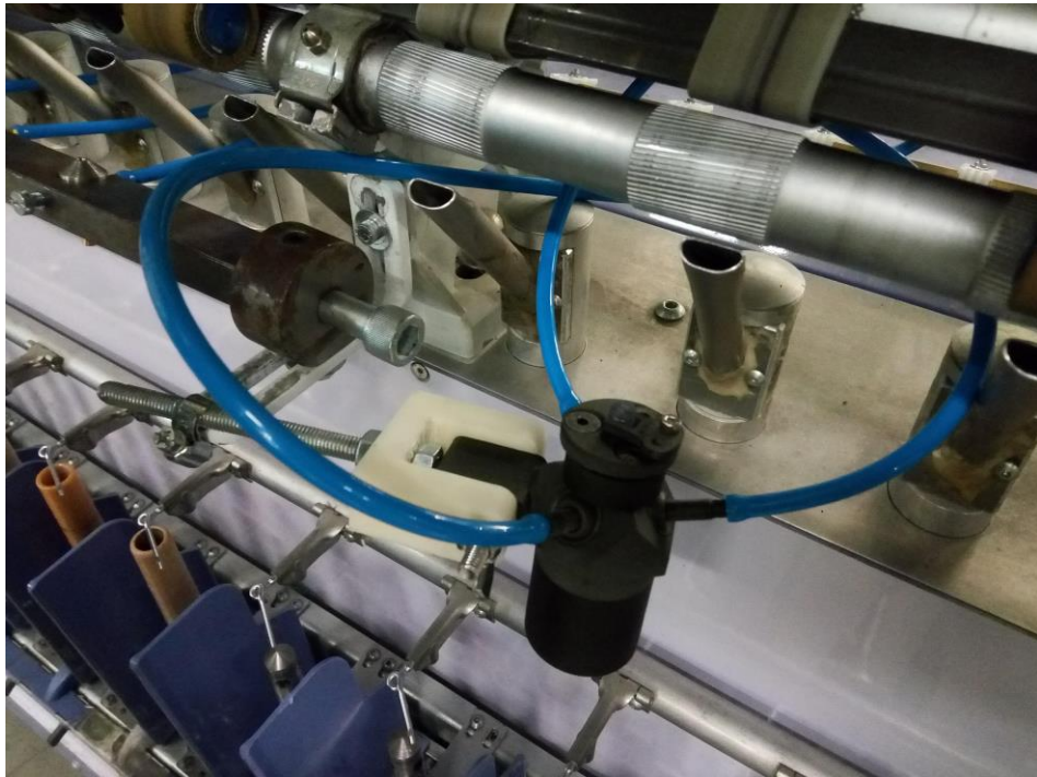
Şekil 3.29. Merlin marka konvansiyonel ring iplik eğirme makinesine modüler hava düzesinin entegre edilmesi
