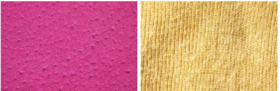
Şekil 3.8. Yüksek tüylülük değerindeki ipliklerden yapılan farklı iki renge sahip örme kumaşlardaki boncuklanma problemi (Uster Technologies AG, 2013)
